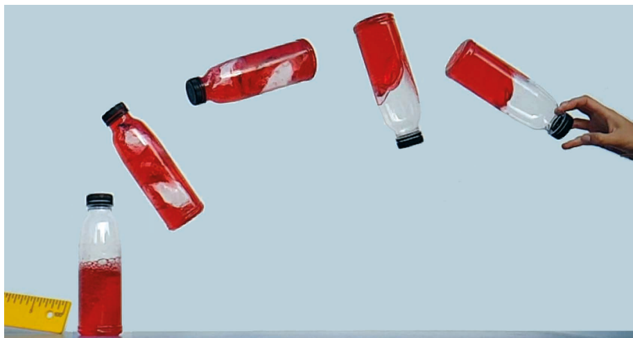
Figure 1 - Chronophotographie d'un lancer de bouteille réussi. L'axe de rotation est perpendiculaire à l'axe de la bouteille (il est perpendiculaire au plan de la figure). Remarque : la trajectoire de la bouteille a volontairement été exagérée pour montrer différentes phases du mouvement.
